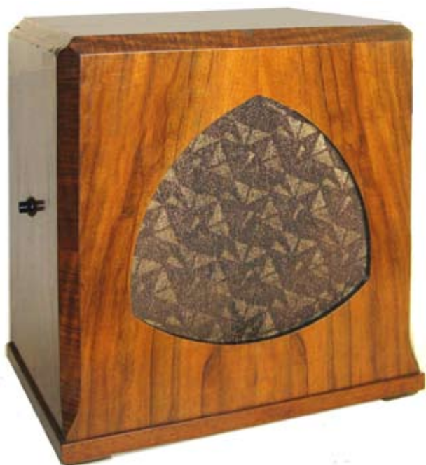
Biennophone NF-Telefonrundsprachapparat von 1932; für die Programmwahl tut's ein einfacher Tastknopf auf der Seite.
