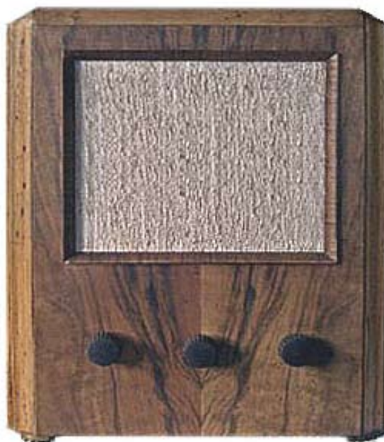
Autophon T2 NF-Telefonrundsprachapparat (1934/35). Ein Drehknopf steht mit dem Programmwahl-Tastkontakt in Verbindung.
