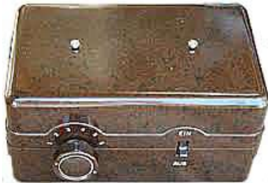
HFTR-Vorsetzer, zum Anschliessen am Grammo-Eingang eines gewöhnlichen Radios, oder an der HiFi-Anlage.
